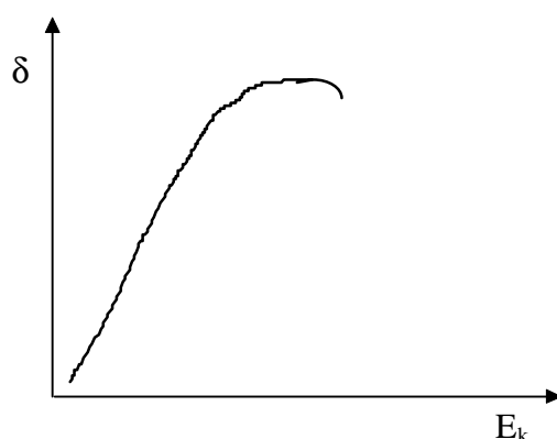
Rys. 3. Zależność współczynnika emisji wtórnej \delta od energii kinetycznej elektronu.
