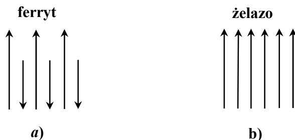
Rys.2 Rodzaj uporządkowania momentów magnetycznych: a) dla ferrytu, b) dla żelaza. Strzałki na rysunku odpowiadają elementarnym momentom magnetycznym w obu substancjach.
